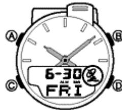
На рисунке изображен общий вид часов в режиме текущего времени. Нажмите кнопку "C" для перехода из режима в режим.
